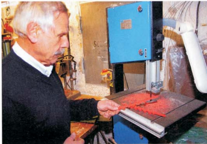
Ständige Kontrollen sind notwendig. Göhre zersägt seine Wurmis, um zu prüfen, ob der Glasfaseranteil optimal und auch richtig verteilt ist.
