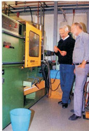
Das Granulat wird im Autoklaven bei Hartmann erhitzt und in eine Werkzeugform gespritzt – entscheidend für die Qualität.
